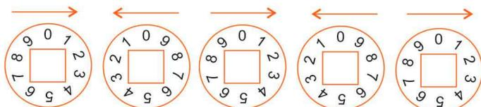
No medidor de ponteiros inicie a leitura da direita para a esquerda
